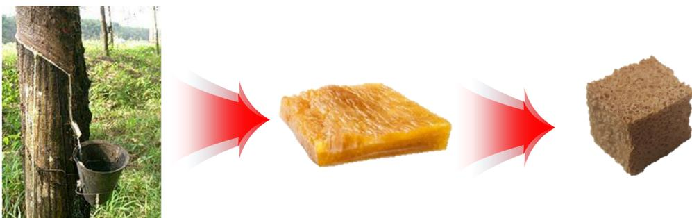
고무는 고무나무 추출액을 굳힌 천연고무에서부터 석유화학의 산물인 합성고무까지 다양한 형태로 존재, 사용되고 있습니다. 이러한 고무의 주요 응용처인 고무 발포체는 가볍고, 특유의 탄성을 가지고 있어 자동차 산업, 포장재, 단열재 등 다양한 방면에서 사용됩니다. 본 연구에서는 다양한 고무원료로부터 고무발포체를 제조하고, 특정 첨가제를 사용하여 물성을 제어하거나, 생분해성 등의 고부가가치 고무 발포체를 제조하기 위한 연구를 진행하고 있습니다.
